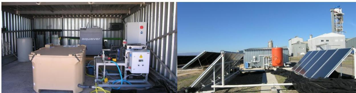
*Fig. 20. Vues internes (à gauche) et externe (à droite) de la plateforme d'essai expérimentale de distillation membranaire dans l'usine PSA de dessalement thermique solaire à basse température*
